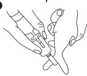
角を落として丸くするようになじってゆくとゆるやかな曲線の輪郭に近づきます。削る部分にあわせて刃物を使い分けて下さい。
