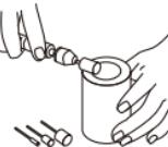
高台や表面の削りはGC系軸付砥石で可、ゆっくり加工して下さい。
